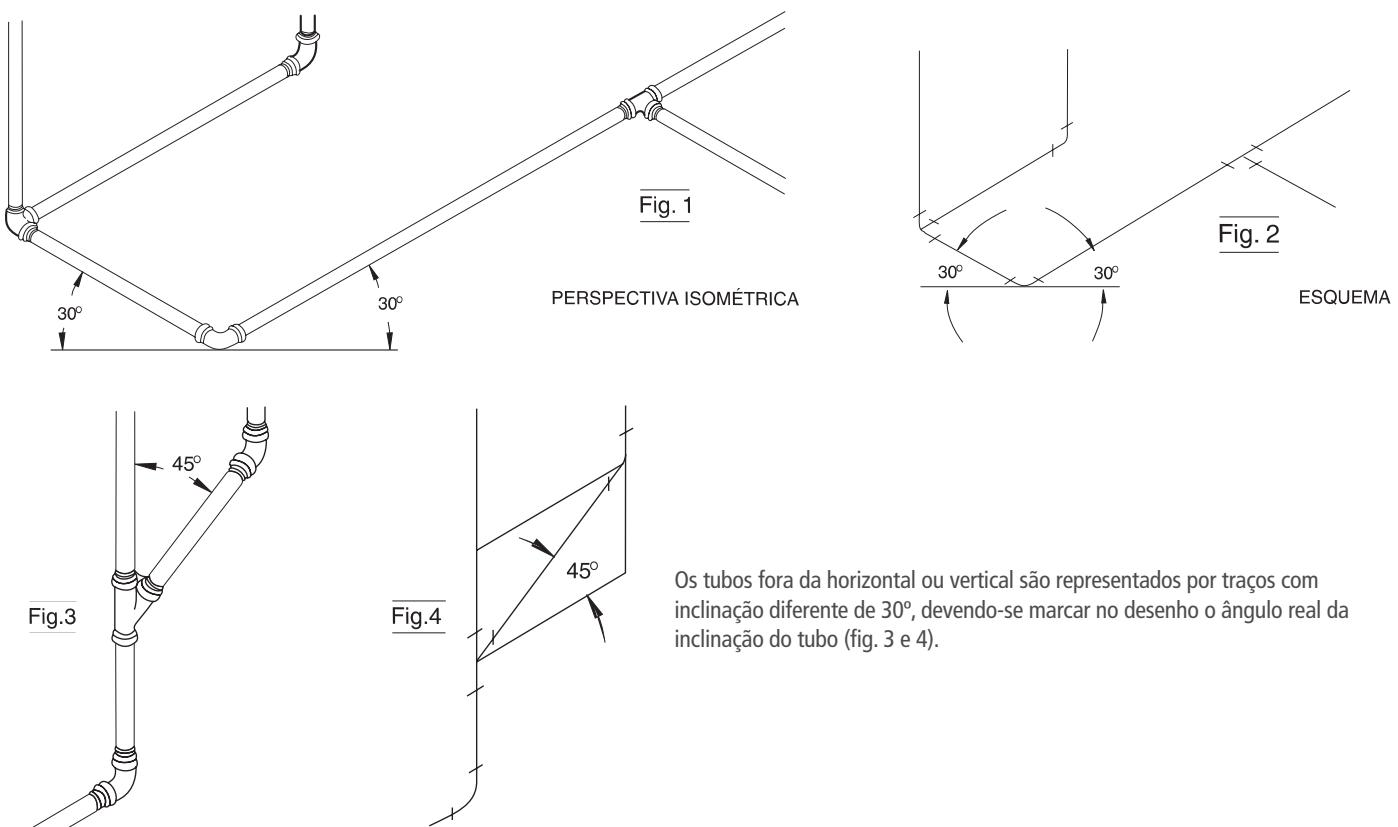
Os tubos fora da horizontal ou vertical são representados por traços com inclinação diferente de 30°, devendo-se marcar no desenho o ângulo real da inclinação do tubo (fig. 3 e 4).
