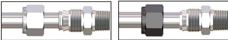
1. Inserir o tubo com as anilhas pré-cravadas na conexão até que assentem no cone do corpo. Observar se as luvas não possuem movimentos longitudinais. Movimentos rotativos das luvas sobre o tubo são admissíveis.
