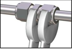
Segurar o corpo da conexão com uma segunda chave, evitando assim que o mesmo gire. Observar pelo desenho que a marcação feita inicialmente dá uma volta completa e pára na posição 9, permitindo facilmente visualizar que a conexão foi corretamente montada.
