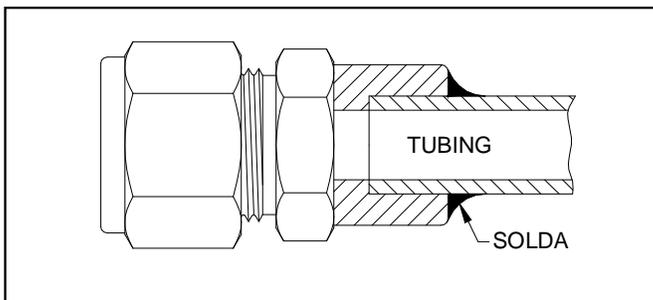
O conector fêmea para solda tipo soquete (931F/7931F) apresenta uma extremidade tipo compressão, enquanto a outra extremidade é para ser soldada a um "tubing". Este tipo de conexão é muito utilizado para facilitar a desmontagem de tubos em sistemas soldados.
