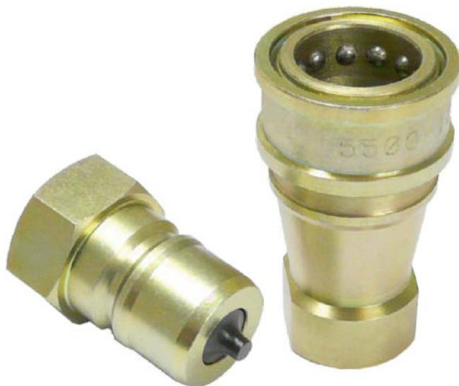
**Dupla Retenção:** Válvulas automáticas tipo "poppet" (cabecote móvel) de ação rápida bloqueiam simultaneamente o fluxo hidráulico no desacoplamento e também simultaneamente no acoplamento as válvulas se abrem reabilitando o fluxo / força hidráulica.
