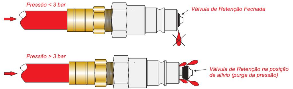
Set Point de atuação da válvula de alívio: mínimo de 3 , máximo de 5 bar. Na situação "**Engate Rápido Conectado (acoplado)**" o pino macho do engate irá operar como um pino valvulado convencional, ou seja ambas as válvulas estarão abertas reabilitando o fluxo / força hidráulica
