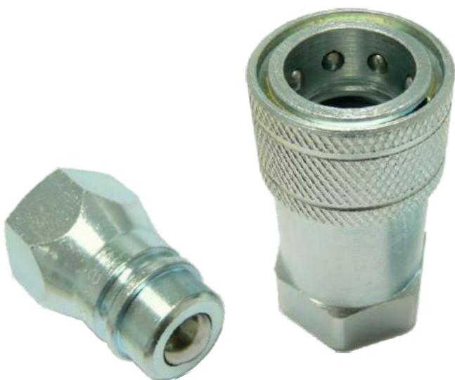
**Dupla Retenção:** Válvulas esféricas automáticas (vedação metal-metal) de ação rápida bloqueiam simultaneamente o fluxo hidráulico no desacoplamento e também simultaneamente no acoplamento as válvulas se abrem reabilitando o fluxo / força hidráulica.
